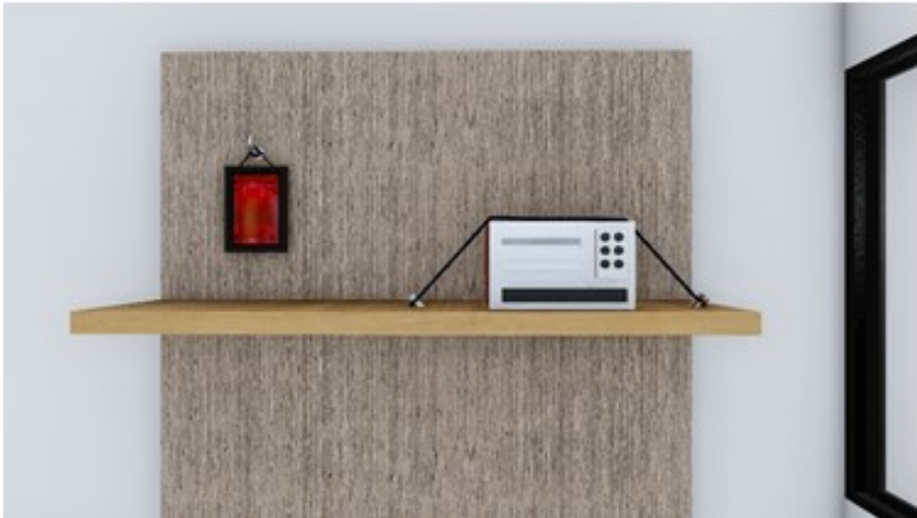
Gambar 13. Komponen non-struktur harus diberi pengaku.
